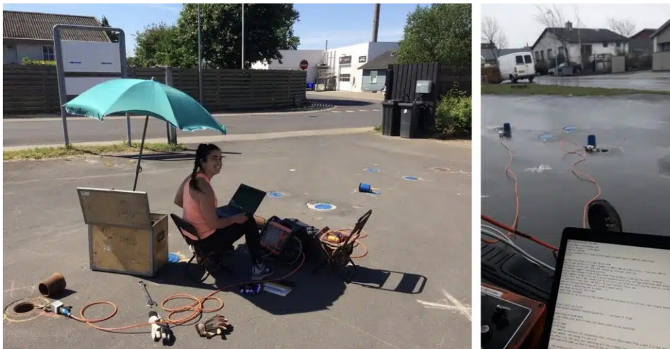
Site contaminé de Farum, dans la banlieue de Copenhague. Photos prises en 2019 et 2020 pendant l'imagerie géophysique des processus de dépollution par traitement in-situ (Léa Lévy).
